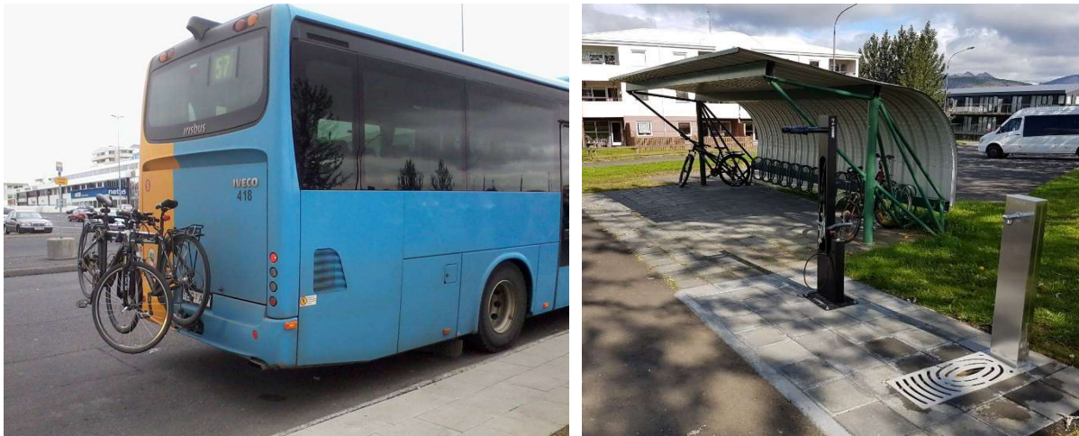
MYND 2.2 Hjólafesting utan á strætó. Hjólstaði í nágrenni strætó biðstöðvar í Mosfellsbæ.
